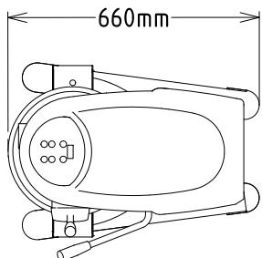
**Elettrico****Tensione di alimentazione:** 200-240 V/1N ph/50/60 Hz**Capacità****Prestazioni (fino a):** 6 kg/ciclo**Capacità** 20 litri**Informazioni chiave****Dimensioni esterne,
